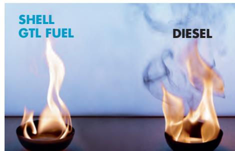
Shell GTL Fuel verbrennt im Vergleich zu konventionellem, aus Mineralöl hergestelltem Diesel effizienter, so dass geringere lokale Emissionen und weniger schwarzer Rauch entstehen.
