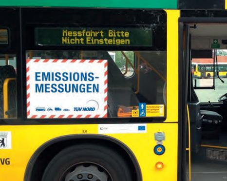
Ein zweitägiger Fahrzeugtest hat die Vorteile von Shell GTL Fuel bei Bussen im öffentlichen Nahverkehr veranschaulicht: eine **Senkung der Emissionen von Stickoxiden (NOx) um mehr als 6%**, und das allein mit einem einfachen Wechsel vom Standard-Diesel auf Shell GTL Fuel.
